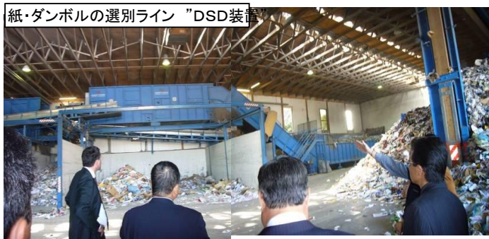
紙・ダンボルの選別ライン "DSD装置"
