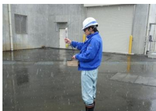
▲ 敷地境界空間線量率の測定
